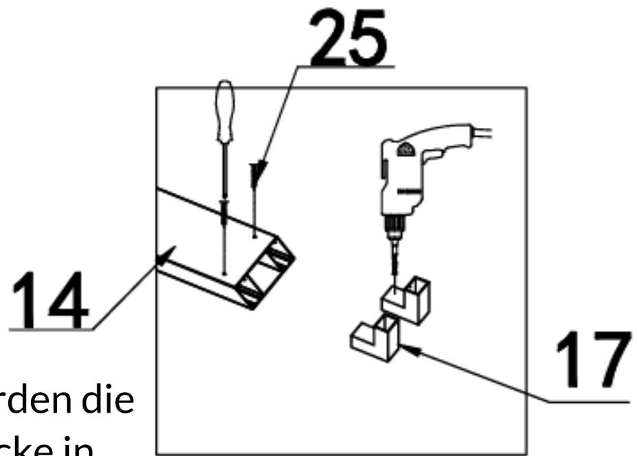
Als nächstes werden die Verbindungsstücke in die dafür vorgesehenen Löcher gesteckt. Bohren Sie danach die Löcher mithilfe eines Akkuschraubers.
