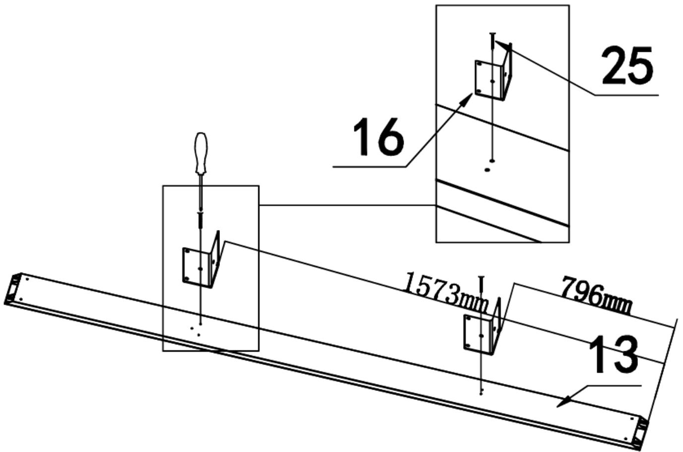
Fixieren Sie die Metallwinkel mit den beiliegenden Schrauben auf den Alublenden.
