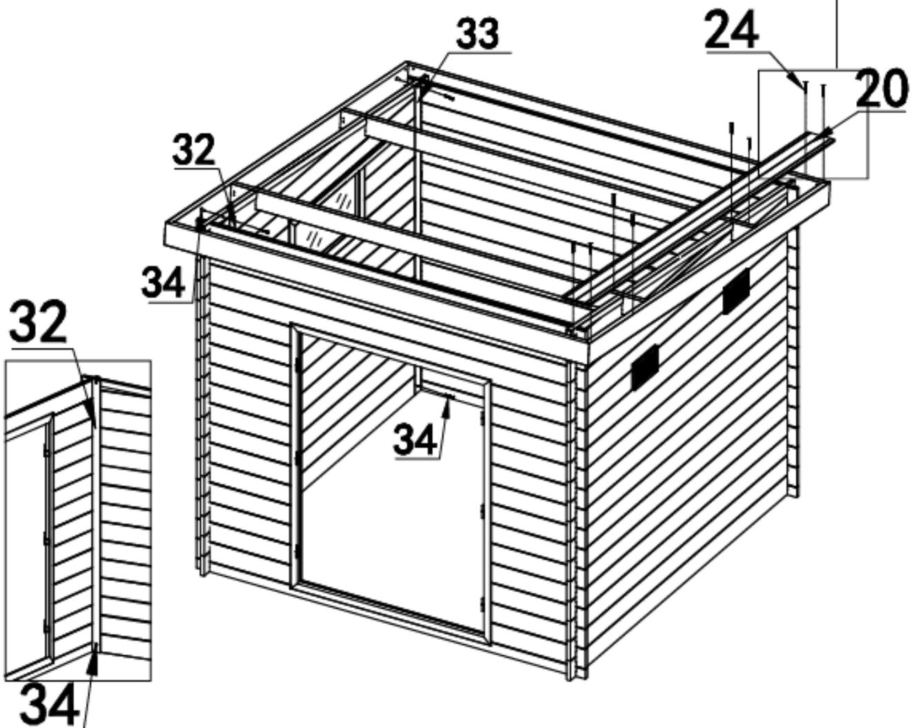
Nach Anbringung der Dachpaneele benötigen Sie eine wetterfeste Dacheindeckung, zum Beispiel unsere selbstklebende Dachbahn (nicht im Lieferumfang enthalten).
