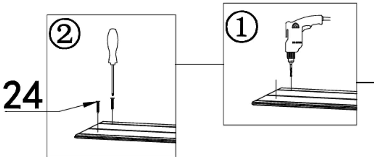
Bevor Sie die Schrauben anbringen, bohren Sie die Löcher vor die Löcher vor.
